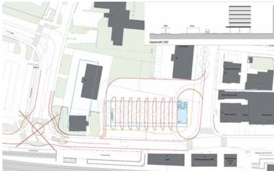
Abb. 26 Buskanten in Parallelanordnung am Standort 1 (Var 1.P). Beispiel mit 90° Senkrechtnanordnung. Der Kreisverkehr ist nur bei Schräganordnungen notwendig. Quelle: metron
