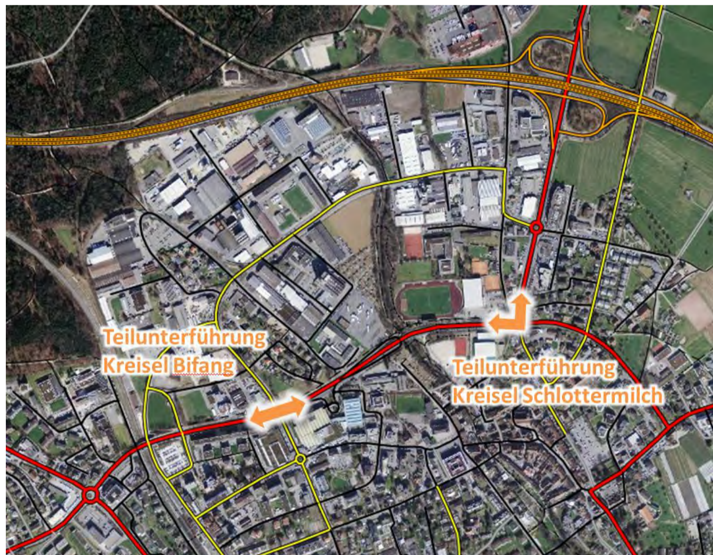
Abbildung 66: Langfristige Massnahmen MIV-Konzept Sursee Plus (Bauprogramme 2030+); Option Teilunterführungen Kreisel Bifang und Schlottermilch Eigene Darstellung Metron, 2016
