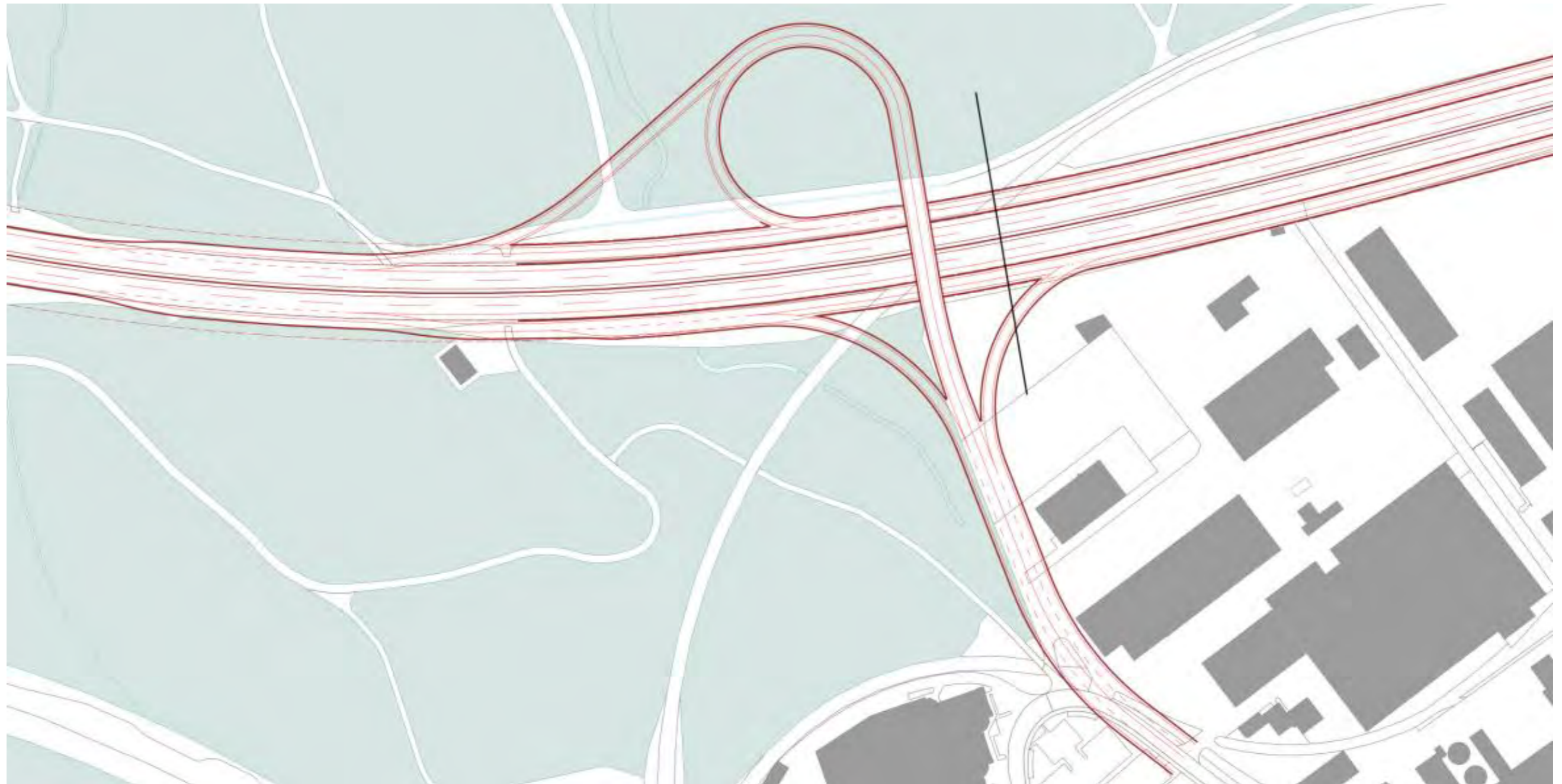
Abbildung 84: Skizze Platzbedarf und Lichtraumprofil Autobahnanschluss Variante 4.1a
