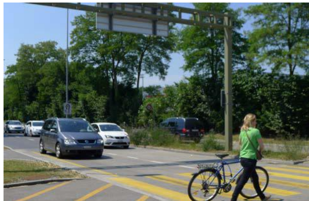
Zwei Fahrstreifen in gleicher Fahrtrichtung vor Querung > grosse Unfallgefahr für Fussgänger und Velofahrer
